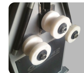
Alüminyum ve Paslanmaz Kıvrım İçin Özel Plastik Vals Topları Delrin Rolls For Aluminum And Stainless
